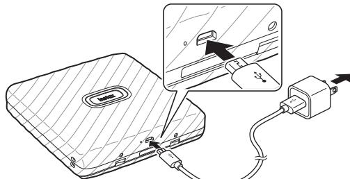
Pripojte tlačiareň pomocou dodaného mikro USB kábla k sieťovému adaptéru USB (dodáva sa so smartfónom) a potom pripojte sieťový adaptér USB k napájaniu vo vnútornom prostredí.
